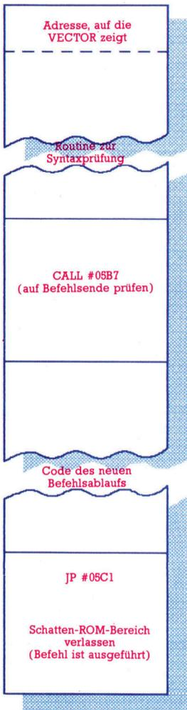
Auf Fehler reagiert der Spectrum mit RST #08. Sobald die Hardware des Interface 1 feststellt, daß der Programmzähler des Z80 diese Adresse enthält, wird das ROM des Interface 1 aktiviert und ein Sprung auf die von VECTOR angezeigte Routine ausgeführt.
